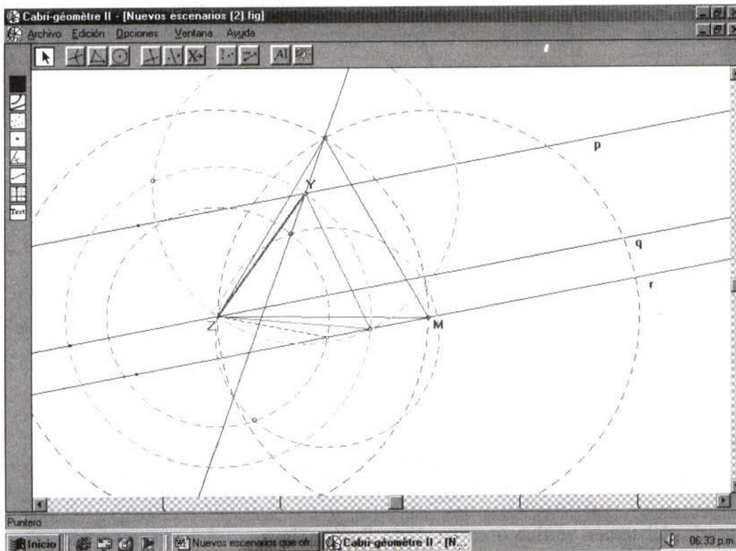
La traza del tercer vértice es la recta, en trazo continuo, que corta a las paralelas y el segmento ZY es el lado del triángulo equilátero que cumple con los requisitos de la construcción solicitada.
